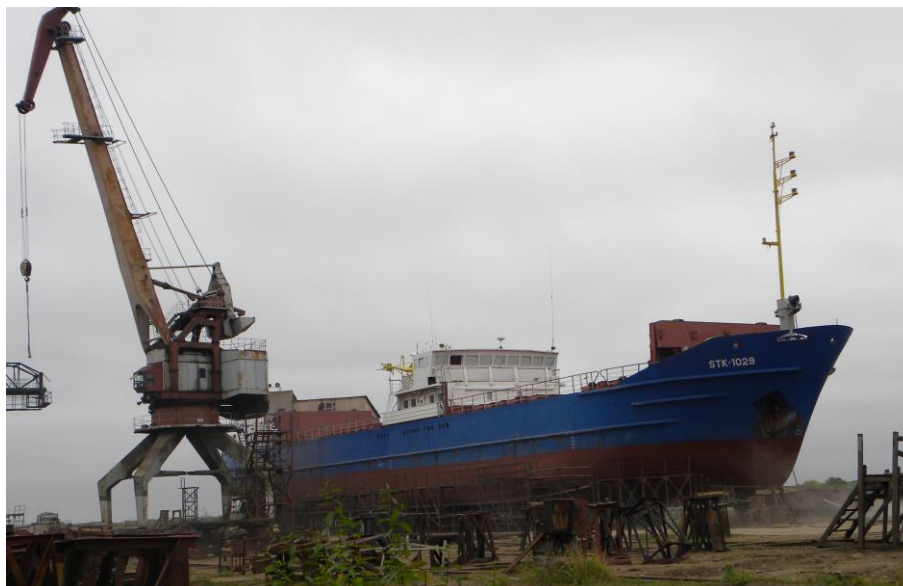
Теплоход «СТК-1029». Ремонт на слипе
